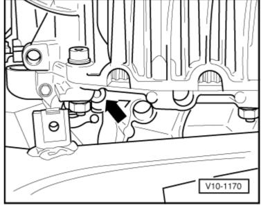
Ouvrir également la vis de vidange de liquide de refroidissement sur le moteur -flèche-.
