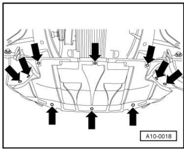
Déposer les vis -flèches- et retirer le support de l'insonorisant.
