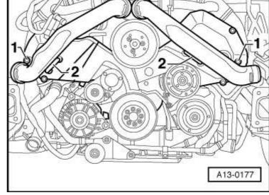
Débrancher le flexible d'huile hydraulique de direction asistée avec le collier de flexible -3094-.
