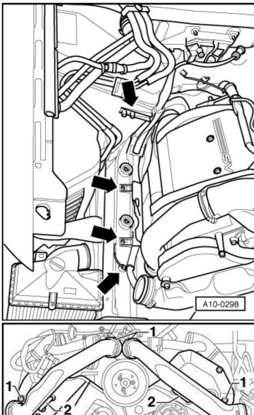
Déposer les vis -1- et retirer les tuyaux de guidage d'air.
