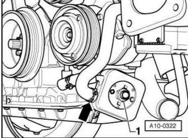
Déposer les vis à gauche et droite - flèches- et retirer la tôle calorifuge d'arbre de pont -1-.
