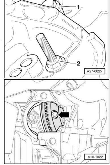
Déposer les 3 vis -flèche- du convertisseur de couple situées dans – l'ouverture laissée par la dépose du démarreur, à l'aide de l'outil spécial - V/175- (faire tourner à chaque fois le vilebrequin d'un <sup>1</sup>/<sub>3</sub> de tour).
