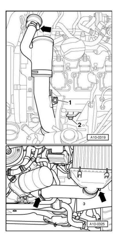
Déposer à gauche et à droite les flexibles de guidage d'air inférieurs entre le turbocompresseur et le radiateur d'air de suralimentation - flèches-.
