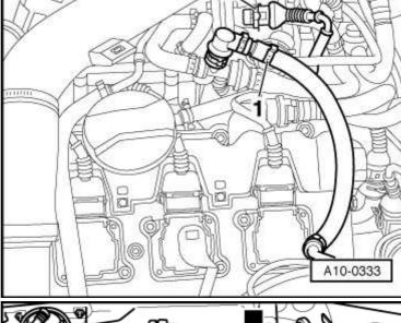
Déposer le répartiteur d'air ; pour ce faire, desserrer les flexibles de raccordement et les raccords -flèches-.
