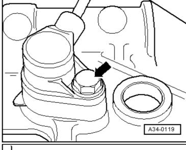
Débrancher le connecteur -flèche- du contacteur de feux de recul -F4- et dégager le câble électrique.
