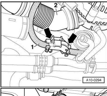
Dévisser le câble de masse -flèche- de l'appui de moteur.
