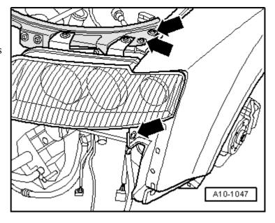
Déposer les vis -flèches- à gauche et à droite au niveau des amortisseurs de chocs.
