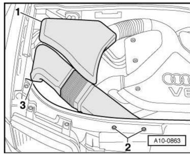
Déposer l'insonorisant ; pour cela, défaire les pièces de fixation -flèches-.
