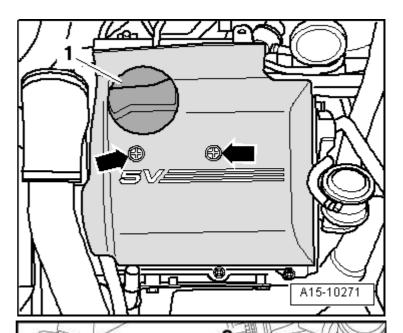
Déposer le flexible de dépression -1allant au réservoir de dépression.
