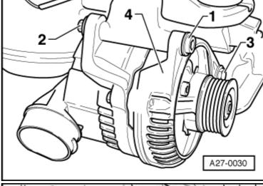
– Desserrer la vis -3- et retirer l'alternateur -4- par le bas.
